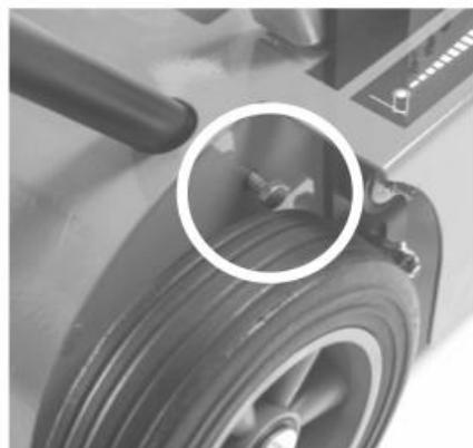
2. Die Druckplatten müssen an der Innenseite der unteren Halterung montiert werden.
