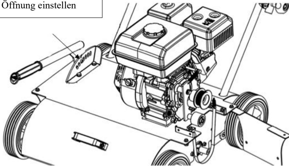
Bei beiden Schrauben lösen, ohne sie vollständig herauszudrehen
